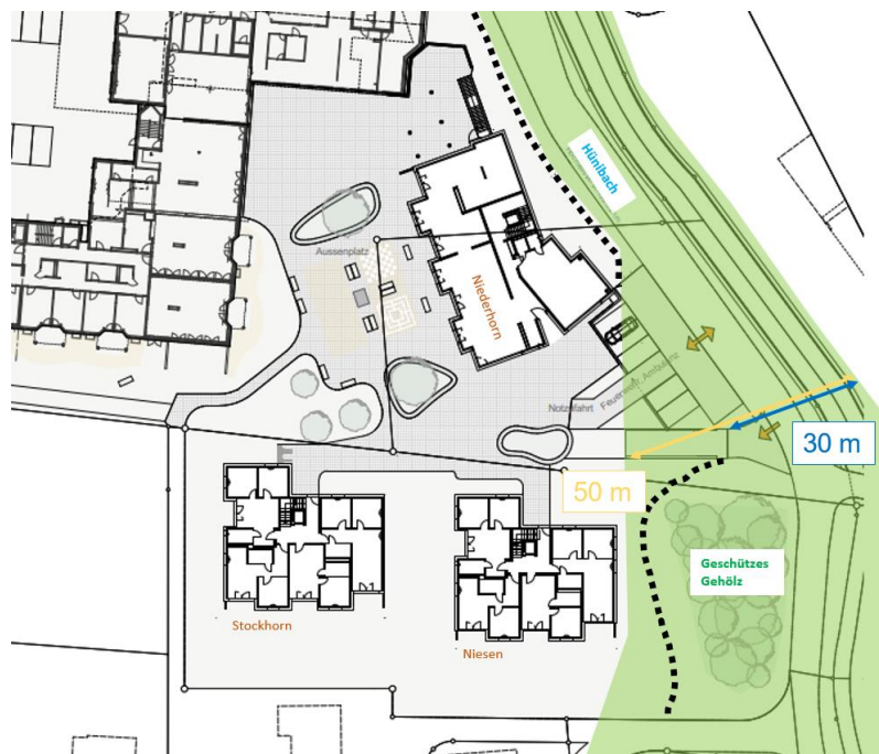
Abbildung 12: Gutachterlich abgeschätzter Abflusskorridor nach Umsetzung der Leitstrukturen im Bereich des Alters- und Pflegeheim Seegarten (schwarz gepunktete Linie = HWS-Damm, rote Linie = HWS-Mauer) im Vergleich zur heutigen Situation (grüne Fläche = mittlere Intensität auf IK HQ 300 ). Die Veränderung des Abflusskorridors an der Engstelle ist in Gelb (Ist-Zustand) und Blau (nach Umsetzung) eingezeichnet.
