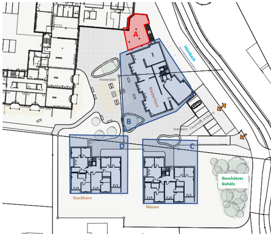
Abbildung 1: Situation Bauvorhaben [1] mit geplanten Neubauten in Blau (Baufeld A und B), geplanter Überdeckung in Rot (Baufeld C), Zufahrt zur Einstellhalle violetter Pfeil, geschütztes Gehölz.
