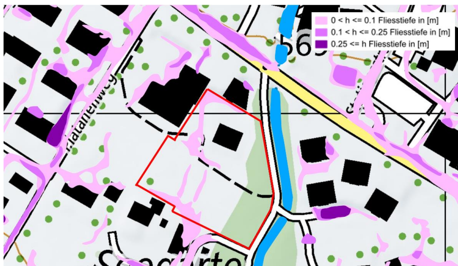
Abbildung 8: Ausschnitt Gefährdungskarte Oberflächenabfluss [5]. Die betroffenen Parzellen sind rot umrandet
