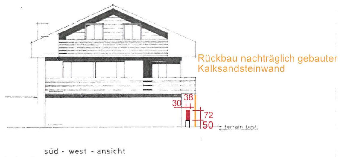
Aufstellung Luft-Wasserwärmepumpe SAS 717x1299x381mm (HxBxT) auf Boden. Höhe ab Boden inkl. Schwingungsdämpfer 800mm. Befindet sich unterhalb Balkon EG und überschreitet die Gebäudeaussenkante nicht.
